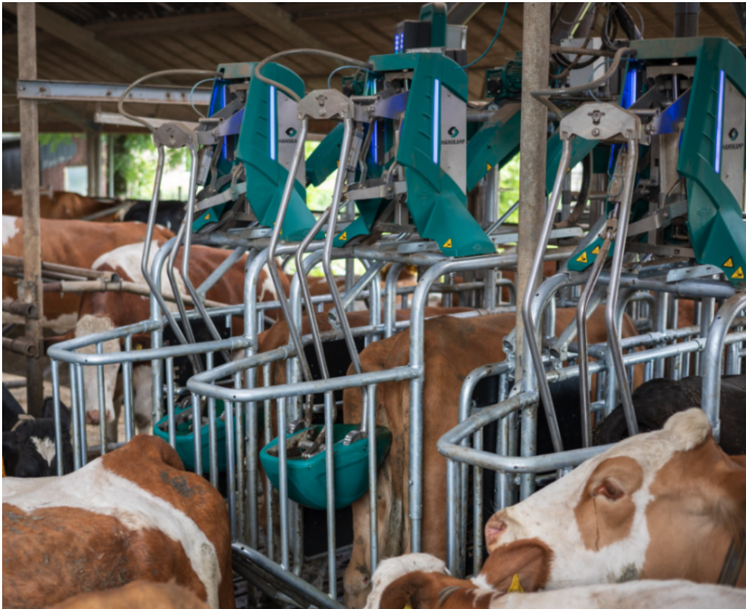
Koetoilet in de melkveestal Foto: Hanskamp
