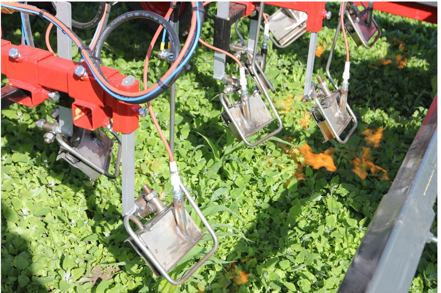
De onkruidbrander van de CIMAT-robot
