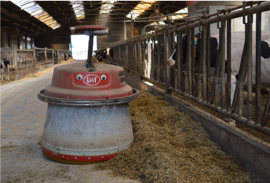
Een voederrobot schuift het voer naar de runderen. De oogjes zijn niet standaard inbegrepen. Foto: VILT
